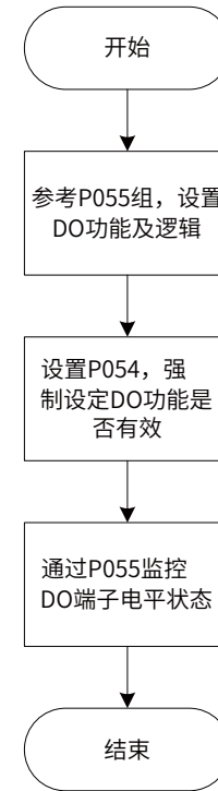
图 7-11 DO 信号强制输出设定步骤示意图
