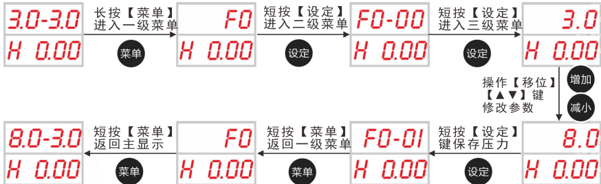
图 4-2-1 LED 键盘三级菜单操作流程图
