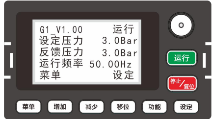
图 4-1-2 LCD 操作面板示意图
