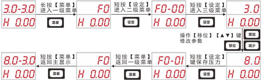
图 4-2-1 LED 键盘三级菜单操作流程图
