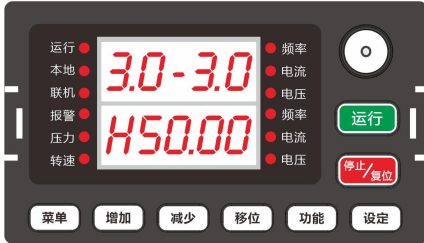
图 4-1-1 LED 操作面板示意图
